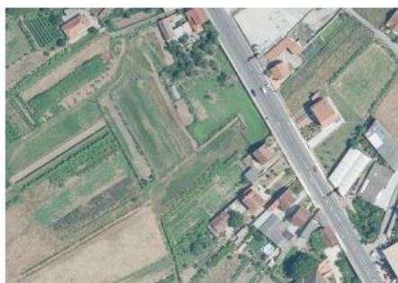
Estado actual do entronque na PO-531. Grafiado no plano se pode ver o final da pista de concentración parcelaria, en zahorra sen conectar coa glorieta
