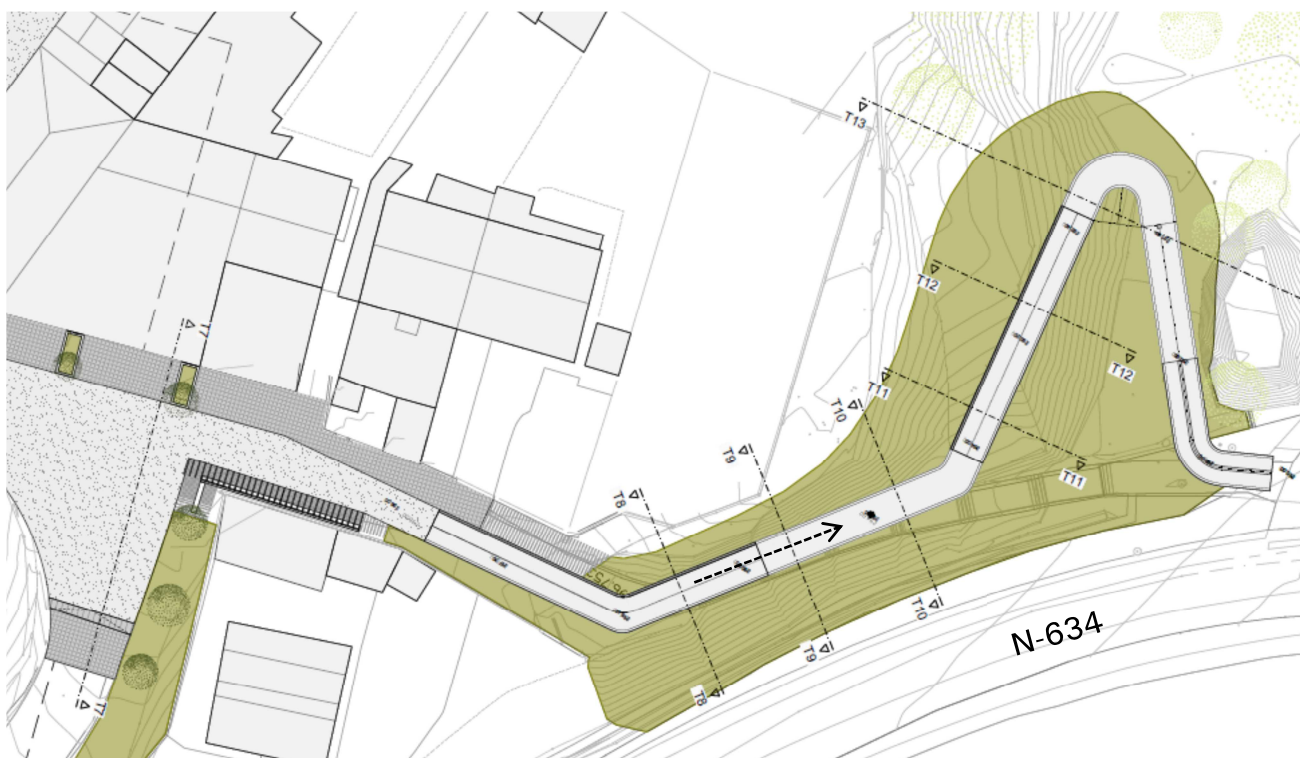
Planta da actuación na zona da baixada á N-634, incluíndo a rampla como pasarela voada
